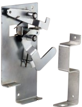
Verrouillage pour empêcher l'ouverture de la porte lorsque le disjoncteur est en position fermée – DLC
